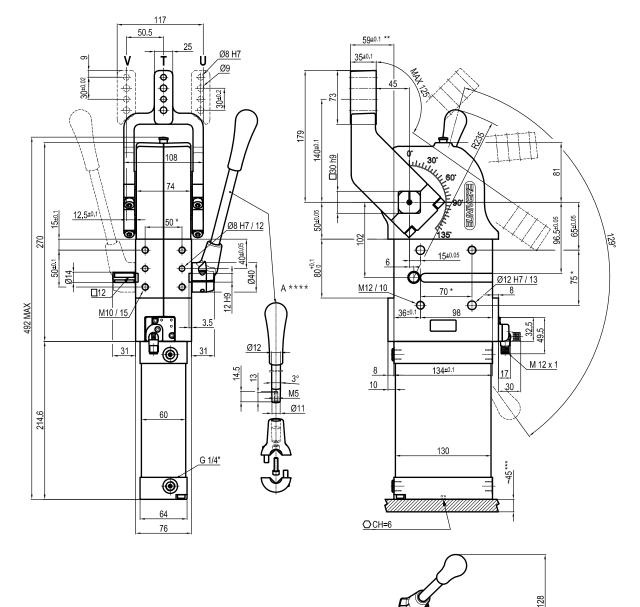
\* : TOLERANCE BETWEEN DOWELS  $\pm$  0,02, BETWEEN SCREW HOLES  $\pm$  0,1
