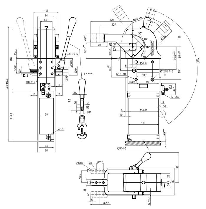
\* : TOLERANCE BETWEEN DOWELS  $\pm$  0,02, BETWEEN SCREW HOLES  $\pm$  0,1 \*\* : TOLERANCE AT 80 mm FROM PIVOT POINT
