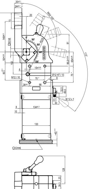
\* : TOLERANCE BETWEEN DOWELS  $\pm$  0,02, BETWEEN SCREW HOLES  $\pm$  0,1
