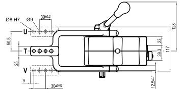
\* : TOLERANCE BETWEEN DOWELS  $\pm$  0,02, BETWEEN SCREW HOLES  $\pm$  0,1 \*\* : TOLERANCE AT 80 mm FROM PIVOT POINT
