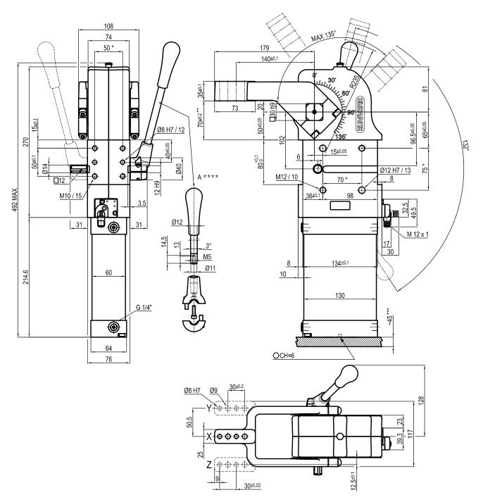
\* : TOLERANCE BETWEEN DOWELS  $\pm$  0,02, BETWEEN SCREW HOLES  $\pm$  0,1 \*\* : TOLERANCE AT 80 mm FROM PIVOT POINT
