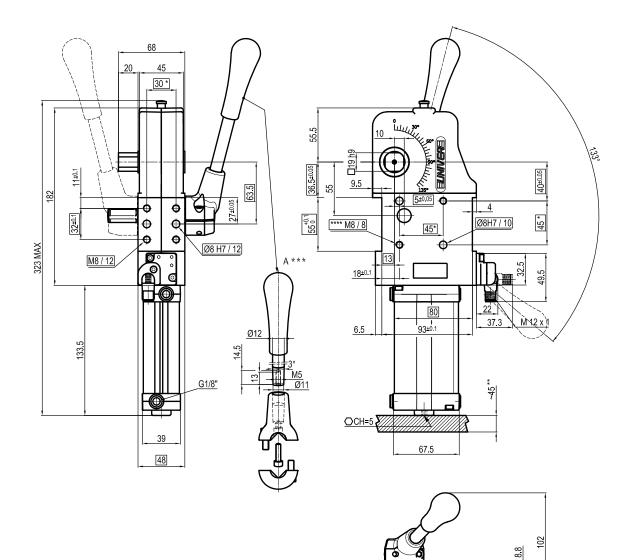
\*: TOLERANCE BETWEEN DOWELS ± 0,02, BETWEEN SCREW HOLES ± 0,1
