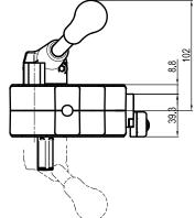
\* : TOLERANCE BETWEEN DOWELS  $\pm$  0,02, BETWEEN SCREW HOLES  $\pm$  0,1
