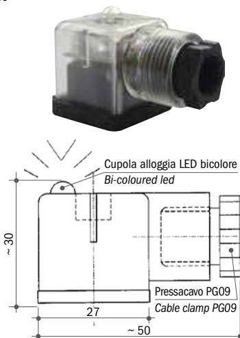
Connettore trasparente con Led bicolore rosso/verde Transparent connector with red/green bi-coloured led Tipo CLB Type
