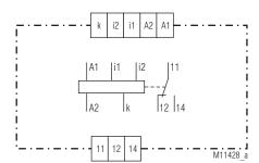
Terminals i1/k: 2 mA ... 11 mA; 0,1 A ... 1,1 A Terminals i2/k: 10 mA ... 110 mA; 1 A ... 10 A
